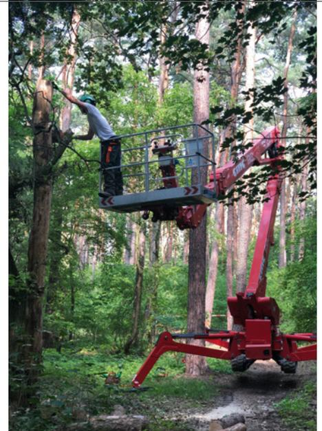
Auch im dichten Baumbestand ist dank Doppel-Teleskoparm und breitem Arbeitskorb effizientes Arbeiten möglich, ohne häufiges Umsetzen der Maschine.
